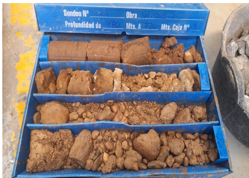
Testigo del sondeo P1 (4,80 – 7,20m)
