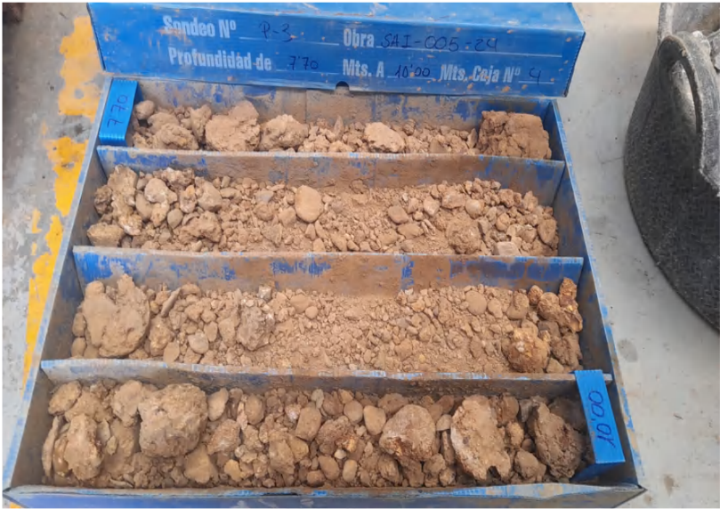
Testigo del sondeo P3 (7,70 – 10,00m)
